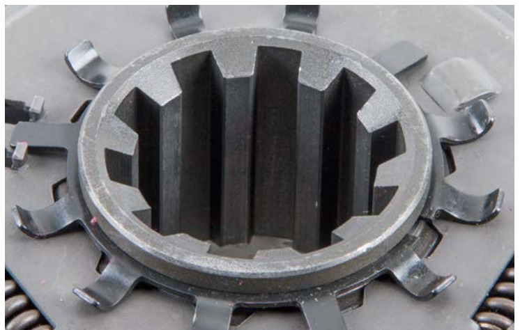
Εικόνα 2: Τα φωσφοριωμένα κέντρα, χρήζουν οπωσδήποτε λίπανσης
