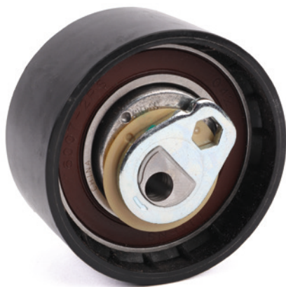
Εικόνα 1: Παλιός σχεδιασμός με τη πλαστική επιφάνεια κύλισης
