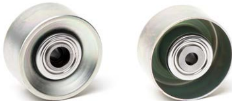
Εικόνα 1: Παράδειγμα μιας τροχαλίας εκτροπής που έχει τοποθετηθεί από τον κατασκευαστή οχημάτων
