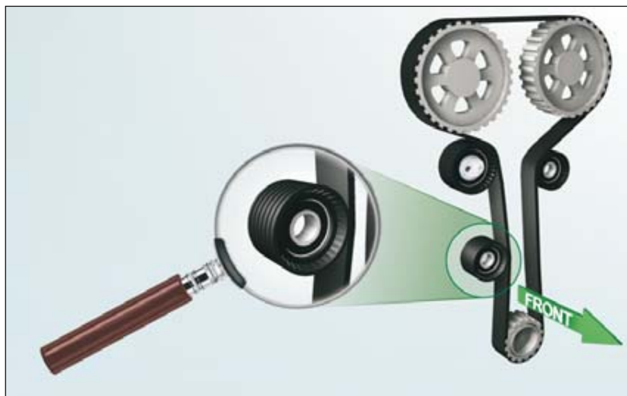
Εικόνα 1: Πορεία του ιμάντα και θέσεις τροχαλιών σε κινητήρα F4R
